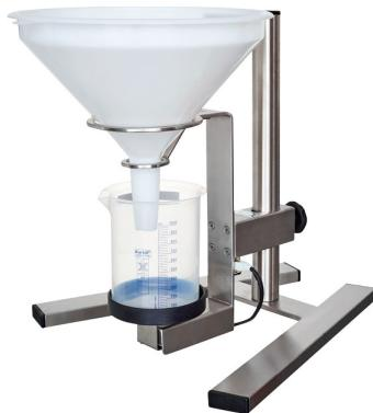
Урофлоуметр Dynamic UFM используется для неинвазивной оценки состояния нижних мочевыводящих путей в урологии и гинекологии. Обеспечивает высокоточные результаты измерения объема и скорости мочеиспускания.
