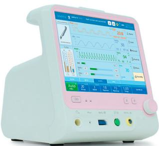
Аппарат ИВЛ S1800 NEO – пневматический электрический аппарат для дыхательной поддержки детей и новорожденных, в том числе недоношенных. Может использоваться как в портативном варианте, так и в мобильном варианте на тележке с колесами.
