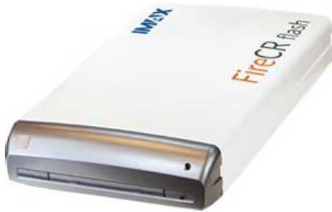
Дигитайзер FireCR Flash Medical – аппарат для оцифровки рентгенографических снимков нового поколения. Оцифровщик Flash продолжает популярный модельный ряд аппаратов FireCR. Новая модель имеет уменьшенные габариты и вес, улучшенное программное обеспечение и оптимизированный алгоритм приема и обработки кассеты.
