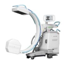
Oscar 15 - мобильный рентгеновский аппарат типа С-дуга с выходной мощностью 15 кВт и плоским детектором CMOS с активной площадью 26х26 сантиметров.
